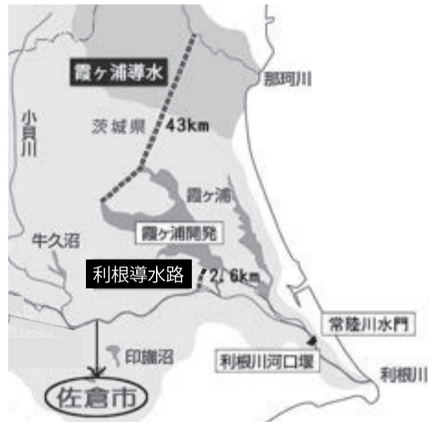
霞ヶ浦導水事業：那珂川・霞ヶ浦・利根川をトンネルでつなぎ、水のやり取りをする事業です。佐倉市分の出資金・負担金は6億3000万円で、4億8600万円は支払い済みです。工事の進捗次第では今後の追加負担もあり得ます。
